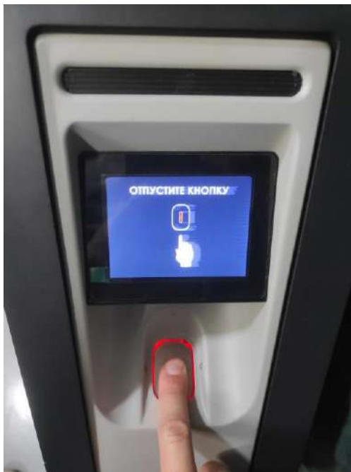
Рис. 1.8 Пример нажатия кнопки УОП
